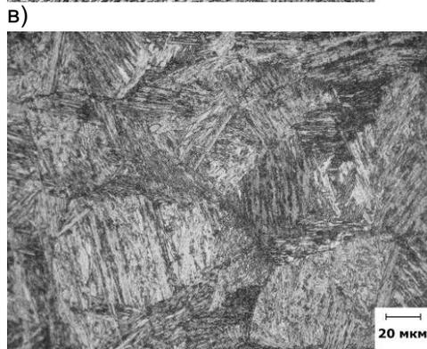
Рисунок 3 – Диаграмма АРА со структурной диаграммой (а) и микроструктура участка перегрева ЗТВ стали 24Х2НАч, охлажденного от температуры 1250 °С, степени деформации  $\epsilon = 20\%$  со скоростью  $\omega_{6/5}$ , °С/с: б) 5,2; в) 7,0; г) 8,5
