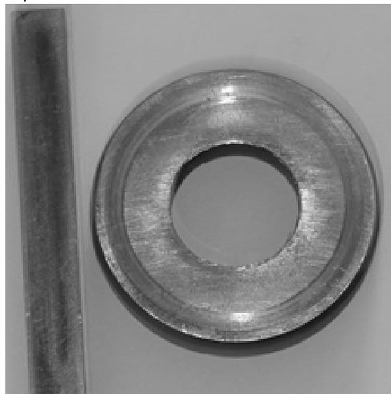
Рисунок 1 - Внешний вид поверхностей трения образцов возвратно-поступательного и торцевого трения при медьсодержащем смазочном материале
