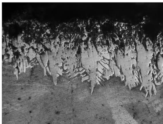
Рисунок 1 – Микроструктура диффузионного слоя, X400
