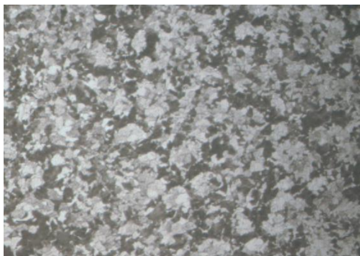
Рисунок 2 – Микроструктура материала рамы боковой после окончательной термической обработки, x100
