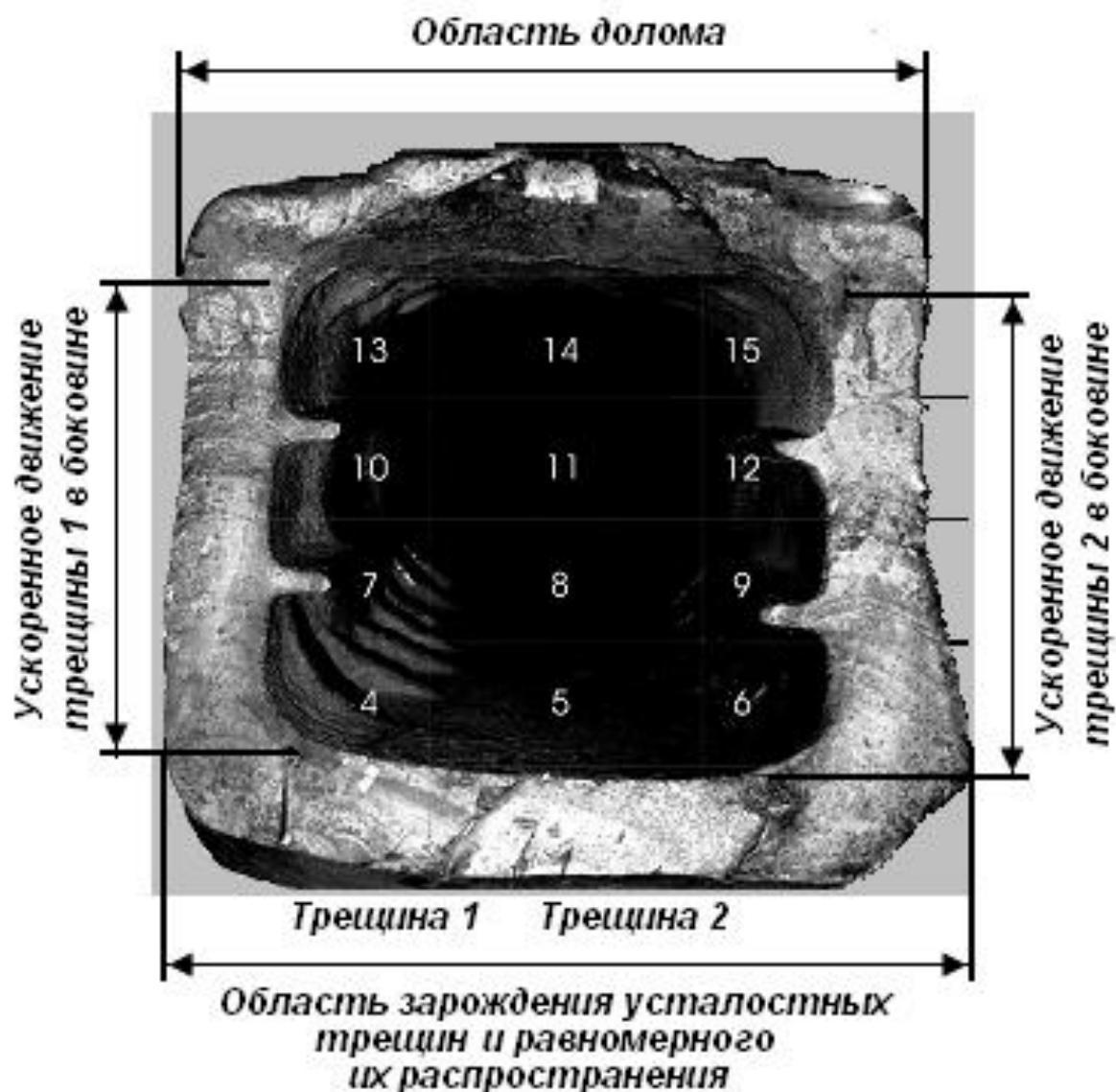
Рисунок 3 – Вид поверхности разрушения боковых рам (на рисунок нанесена сетка для ориентации по участкам излома)
