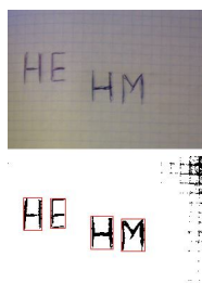
Рисунок 1 – Сверху изображение полученное программой с камеры, снизу уже обработанное с выделенными символами
