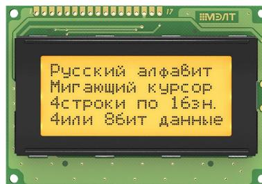
Рисунок 2 – Внешний вид ЖКИ МТ-16S4А
