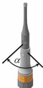
Рисунок 1 – Отсчет угла поворота рабочего инструмента относительно преобразователя
