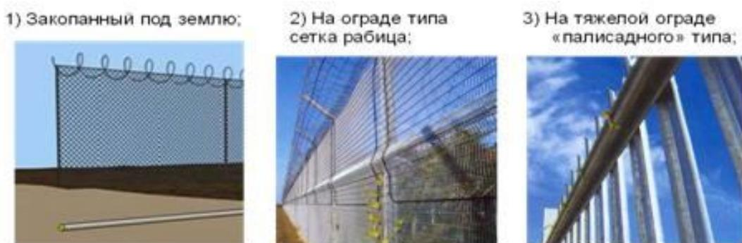
Рисунок 4 Варианты установки волоконно-оптической системы охраны периметра на брэгговских решетках
