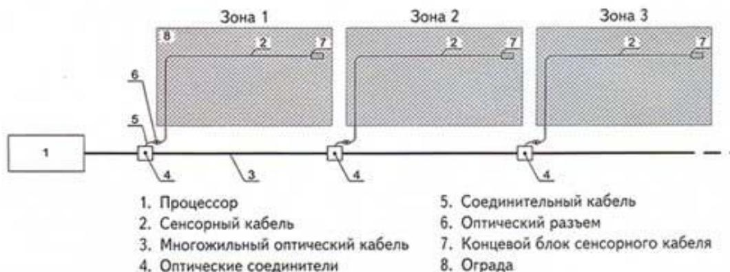
Рисунок 1 – Волоконно-оптическая система охраны периметра на металлической ограде
