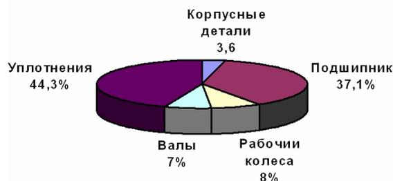
Рисунок 1 – Диаграмма распределения повреждений по элементам насоса
