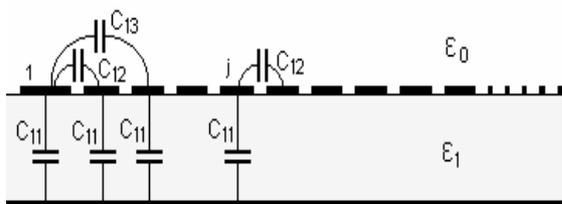
Рисунок 1 – Электрическая модель многопроводной линии связи.
