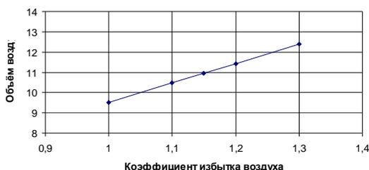
Рисунок 1 – Зависимость объема воздуха от изменения коэффициента избытка воздуха
