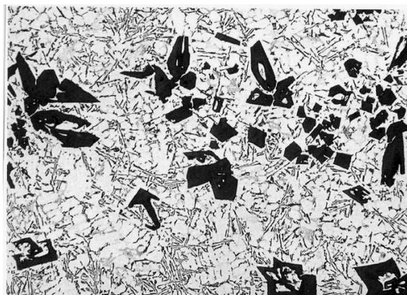
Рисунок 2 – Структура заэвтектического силумина (Al-18%Si) по данным [2]
