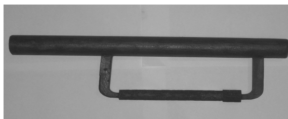
Рисунок 3 – Газифицируемая модель детали «Ось замка» покрытая огнеупорным покрытием и насыщающей обмазкой
