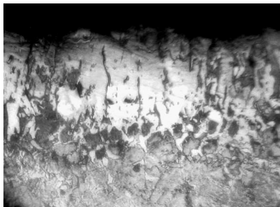
Рисунок 2 – диффузионный слой на стали 5ХНВЛ при режиме: t = 950\text{ }^{\circ}\text{C} , \tau = 5\text{ ч} ; \times 400 . Толщина слоя = 145–160 мкм
