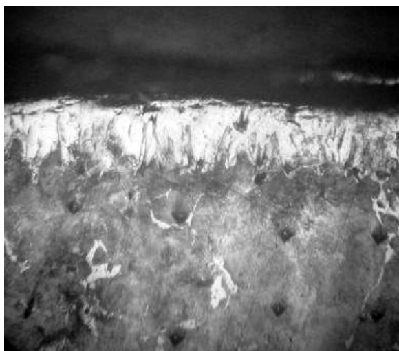
Рисунок 3 – микроструктура диффузионного слоя на стали 55Л при режиме: t=950\text{ }^{\circ}\text{C} , \tau = 3\text{ ч} ; а) \times 200 , Толщина слоя = 85–95 мкм
