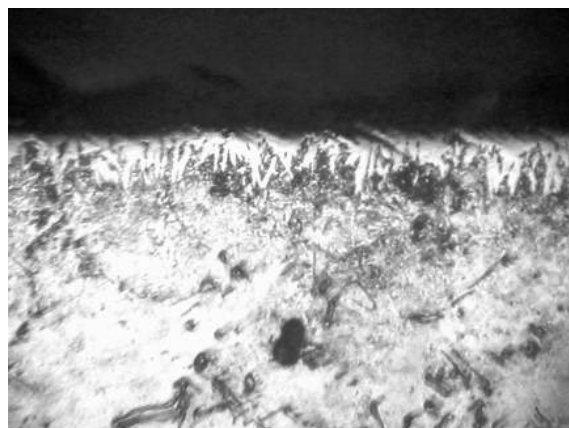
Рисунок 1 – Диффузионный слой на стали 5ХНВЛ при режиме: t=850\text{ }^{\circ}\text{C} , \tau = 3\text{ ч} ; \times 200 . Толщина слоя = 30–40 мкм
