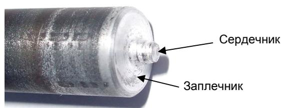
Рисунок 1 – Внешний вид поверхности рабочего инструмента
