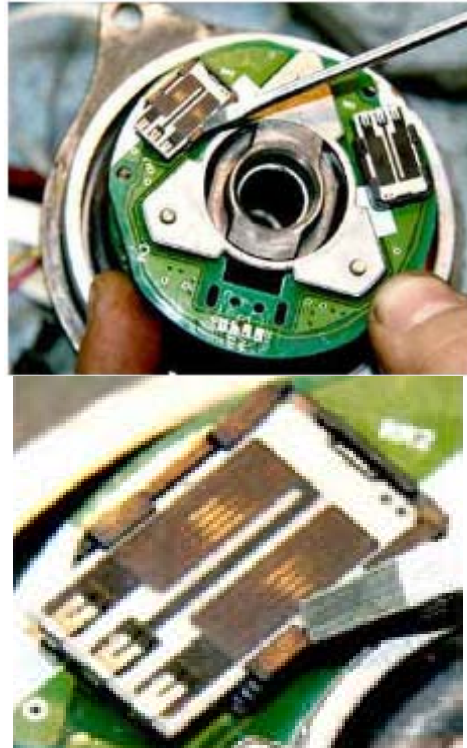
Рисунок 4 - Истончение контактного слоя резистивной дорожки
