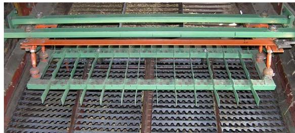
Рисунок 1 – Адаптер системы очистки для работы зерноуборочного комбайна на склонах: 1 – решето адаптера; 2 – подвеска; 3 – тяга; 4 – тяга винтового механизма; 5 – поперечная балка
