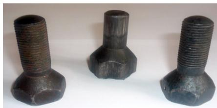
Рисунок 5 – Выдавленные болты из стали 45
