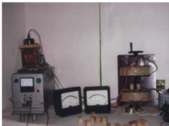
Рисунок 1 – Общий вид установки для воздействия магнитным полем на образцы из полимерной составляющей клея
