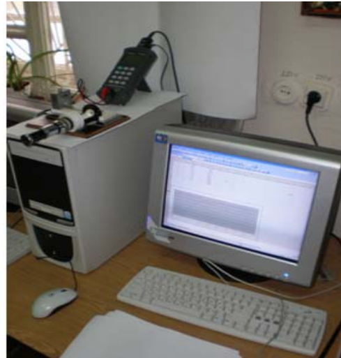
Рисунок 7 – Установка для определения внутренних напряжений клеевых соединений
