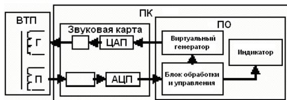
Рисунок 1 – Структурная схема программно-аппаратного комплекса прибора ИЭНМ-10
