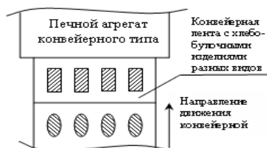
Рисунок 1 – Схематическое изображение процесса загрузки хлебобулочных изделий в печной агрегат
