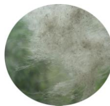
Рисунок 3 – Внешний вид базальтовой матрицы волокнистого сорбента
