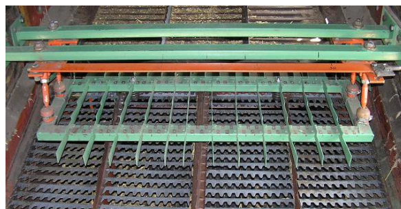
Рисунок 1 – Адаптер системы очистки для работы зерноуборочного комбайна на склонах: 1 – решето адаптера; 2 – подвеска; 3 – тяга; 4 – тяга винтового механизма; 5 – поперечная балка
