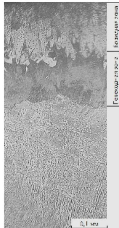
Рисунок 2 - Микроструктура борированной стали 20ХЛ (опыт №3:  $t_{\text{max}} = 970^{\circ}\text{C}$ ,  $t_{\text{min}} = 720^{\circ}\text{C}$ ,  $T_{\text{max}} = 30$  мин,  $T_{\text{min}} = 5$  мин, 5 циклов)
