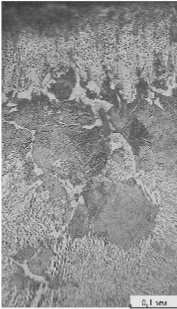
Рисунок 3 - Микроструктура борированной стали 20ХЛ (опыт №3:  $t_{\max} = 970^{\circ}\text{C}$ ,  $t_{\min} = 720^{\circ}\text{C}$ ,  $T_{\max} = 30$  мин,  $T_{\min} = 5$  мин, 5 циклов)
