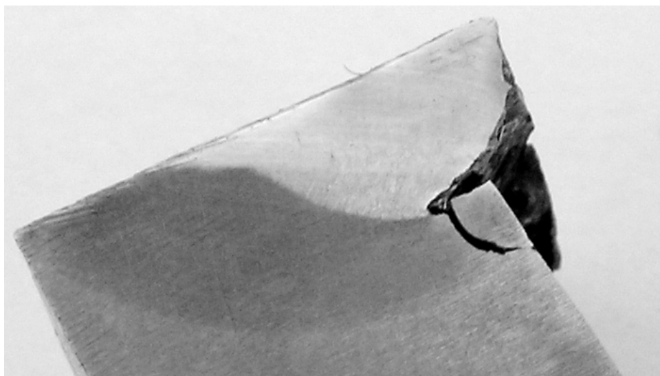
Рисунок 5 - Макроструктура металла поперек излома (ООО "Микроакустика")
