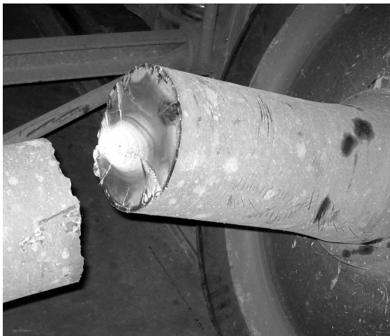
Рисунок 1 - Вид разрушенной оси
