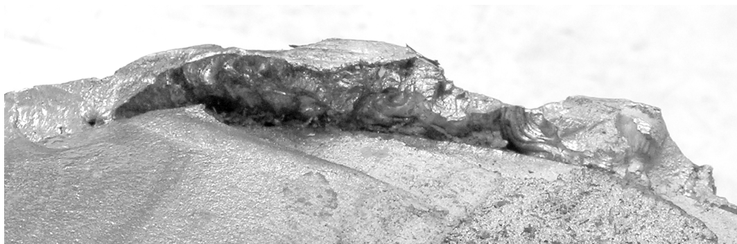
Рисунок 4 - Участок излома с темными включениями
