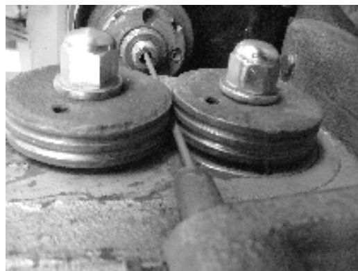
Рисунок 2 – Станок для рубки проволоки с упрочненными роликами
