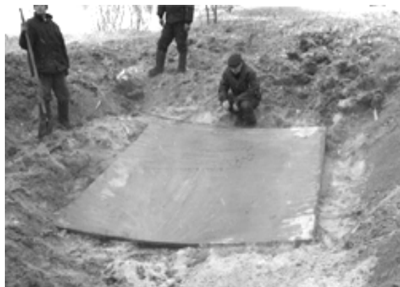
Рисунок 2 – Биметаллический лист «сталь 09Г2С + титан ВТ1-0» размером 35×2000×3000 мм с плакирующим слоем толщиной 5 мм, сваренный взрывом
