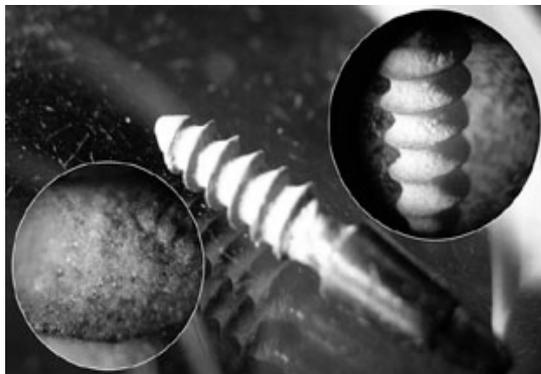
Рисунок 1 – Дентальный имплантат, обработанный микродуговым оксидированием
