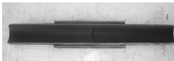
Рисунок 3 – Общий вид образцов-сегментов сварных муфтовых соединений
