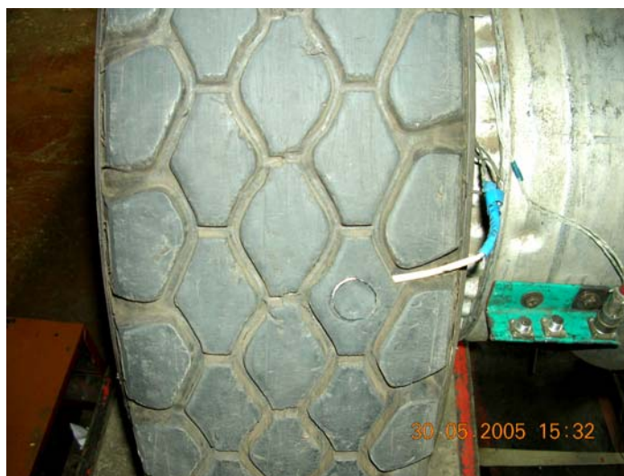
Рисунок 2 – Испытуемое колесо с устройством для измерения напряжений
