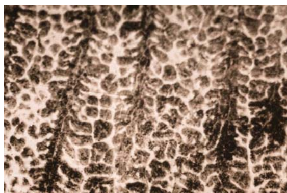
Рисунок 2 – Микроструктура наплавленного металла 20X13
