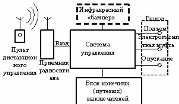
Рисунок 2 – Схема системы управления автоматическими гаражными воротами
