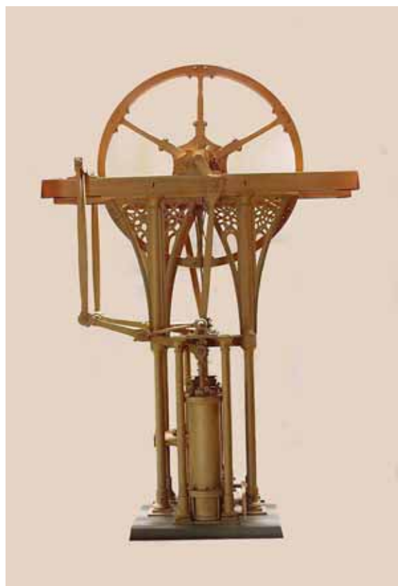
Рис. 4. Сдвоенная вертикальная паровая машина простого действия. 1829 г. Фрейбергские рудники. Германия. Модель в масштабе 1:8 изготовлена во Фрейберге в 1837 г. мастером Ф.А. Клопфером
