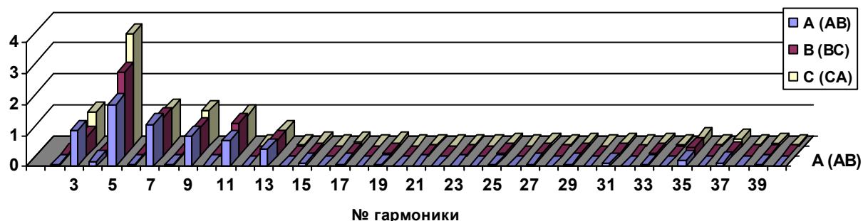
Рисунок 5 – Результаты испытаний электрической энергии по коэффициенту n-й гармонической составляющей напряжения
