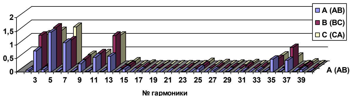
Рисунок 1 – Результаты испытаний электрической энергии по коэффициенту n-й гармонической составляющей напряжения
