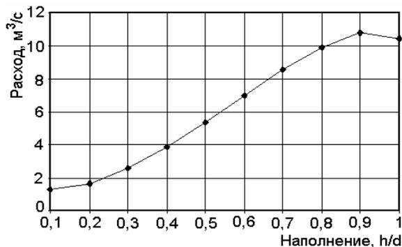
Рисунок 5 – Наполнение трубопровода на уч. 2
