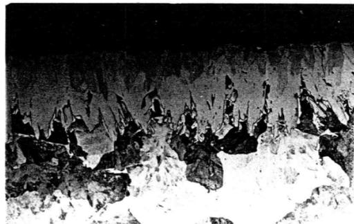
Рисунок 1 – Микроструктура боридного покрытия стали 45, полученного в насыщающей смеси: 46%(80% $B_4C$  + 20%  $B_{ам}$ ) + 50%Cu + 4%  $KBF_4$  (x175)
