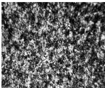
Рисунок 3 – Структура стали 50ХФА после выдержки в свинцовой ванне в течение 15 с при температуре 450^{\circ}\text{C} и быстром охлаждении ( \times 200 )
