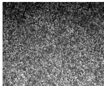
Рисунок 4 – Структура стали 50ХФА после выдержки в свинцовой ванне в течение 20 с при температуре 450^{\circ}\text{C} и быстром охлаждении ( \times 200 )
