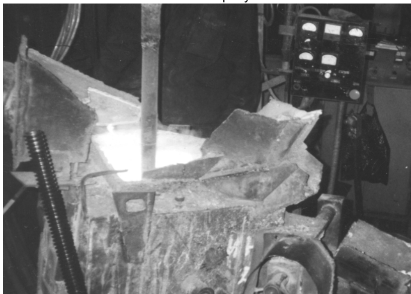
Рисунок 1 – Внешний вид установки электрошлаковой тигельной плавки
