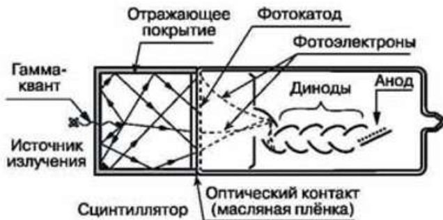
Рис. 1. Схематическое устройство сцинтилляционного детектора
