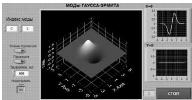
Рис. 1. Вид лицевой панели компьютерной модели, демонстрирующей пространственное распределение моды TEM_{01}
