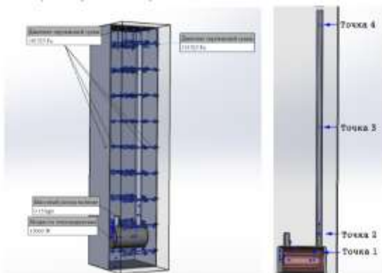
Рис. 1. Модель проточного водонагревателя и точки, в которых будут производиться измерения температур
