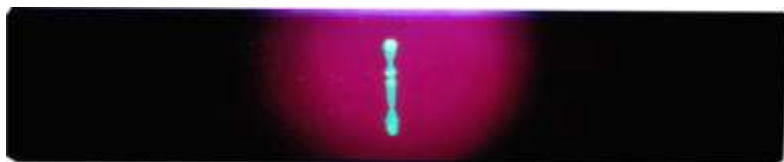
Рис. 2. Результаты контроля полученные при облучении светодиодным фонарем Labino Torch Spotlight UVG2 (365нм)
