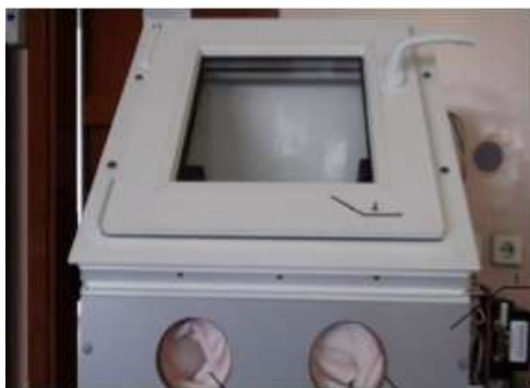
Рис. 1. Экспериментальная установка Условные обозначения: 1 – каркас установки; 2 – отверстия для рук; 3 – резиновые перчатки; 4 – пластиковое окно
