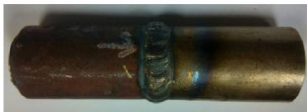
Рисунок 1 – Фрагмент трубы со сварным швом
