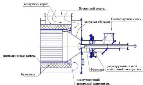
Рисунок 3 – Эскиз муфельной горелки
