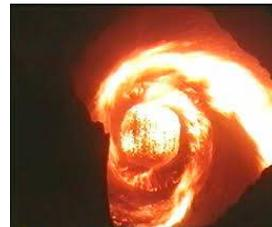
Рисунок 7 – Вихревой способ сжигания лузги подсолнечника
