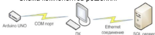
Рисунок 3 – Схема работы программно-аппаратного комплекса – личного считывателя карт
