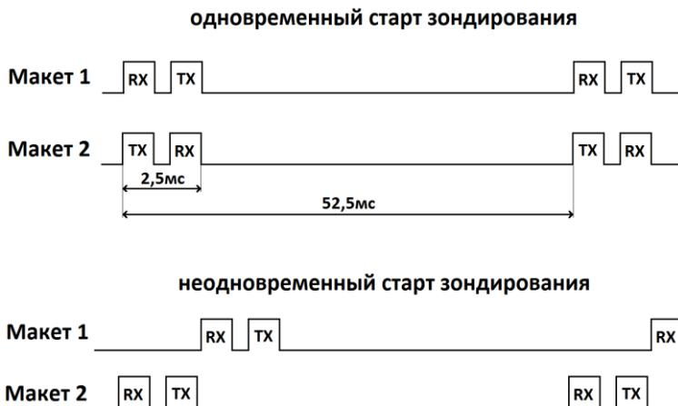
Рис. 3. Временная диаграмма обмена зондирующими сигналами
