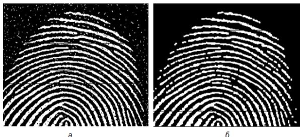
Рис. 3. Результат совместной работы операций «расширение» и «сужение»: а) исходное изображение; б) результат
