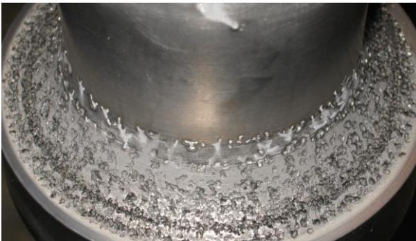
Рис. 3. Кавитационный износ ультразвукового инструмента
