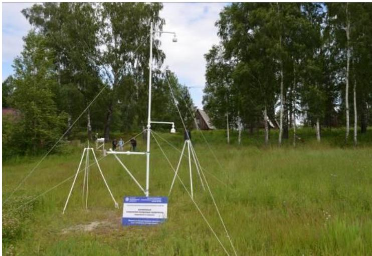
Рис. 1. Стационарный блок АПИК в сборе
