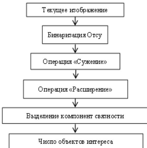
Рис. 1. Алгоритм обработки изображений для подсчета объектов интереса
