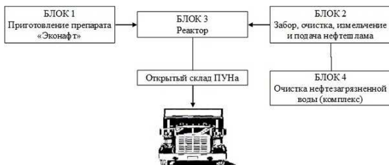
Рисунок 1 - Аппаратурно-технологическая схема ПТК-ИНСТЭБ-ЭКО-5
