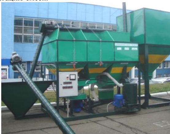
Рисунок 19 – Комбикормовый агрегат производительностью 3 т/ч (разработка Алтайского ГАУ)
