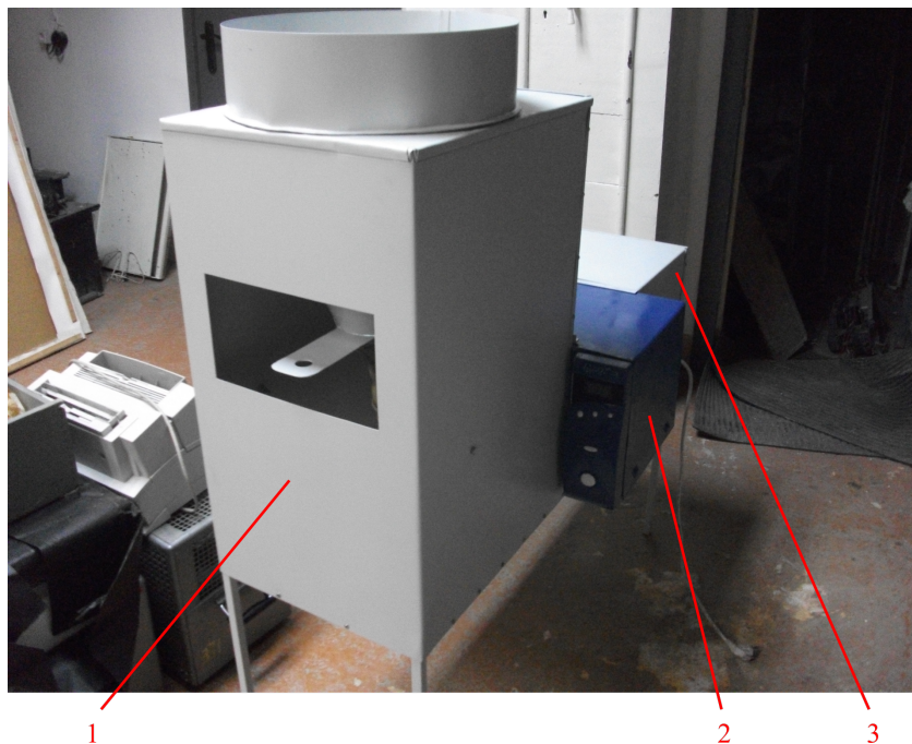
Рисунок 7 – Опытная СВЧ-установка для обработки зерна: 1 — блок подачи зерна; 2 — рабочая камера; 3 — выходной блок
