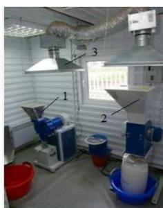
*Рисунок 19 – Мини-цех по переработке рогов оленей северных: 1 – машина для резки и измельчения рогов оленей северных; 2 – автоматический просеиватель; 3 – вытяжка*
