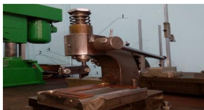
Рисунок 14 – Приспособление для определения оптимальной формы режущей кромки: 1– ручной пресс с регулируемым усилием; 2 – регулировочные винты; 3 – сменное лезвие; 4 – хвостовик; 5 – корпус устройства
