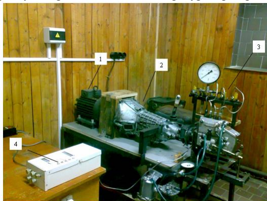
Рисунок 6 – Установка СМТА-01: 1 – электродвигатель; 2 – элементы механического привода; 3 – испытуемая топливная аппаратура; 4 – электронный блок управления
