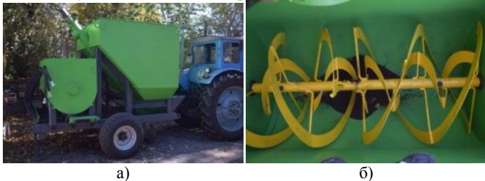
Рисунок 9 – Экспериментальная установка: а – общий вид; б – ленточно-винтовая мешалка
