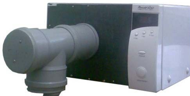
Рисунок 14 – Внешний вид экспериментальной установки обеззараживания семян энергией СВЧ – поля
